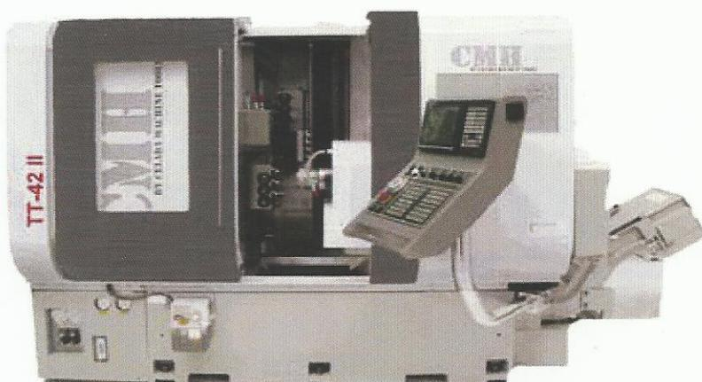
Il tornio CMH TT42/TT60, dotato di una struttura rigida e compatta, è studiato e realizzato per rispondere all'esigenza di **produrre pezzi medio complessi con una riduzione considerevole dei tempi ciclo**, grazie alla possibilità di lavorazioni simultanee fronte/retro di tornitura, fresatura, maschiatura e fresatura.
